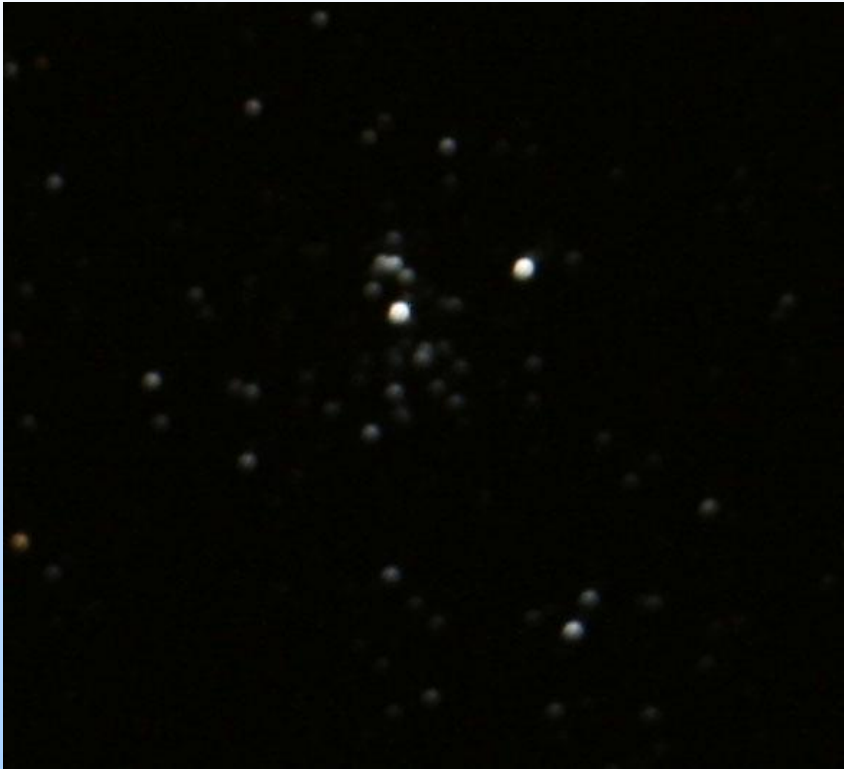
Mauvaise mise au point, télescope décollimaté
